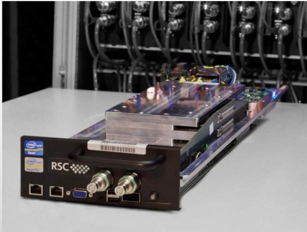
**Вычислительный узел «РСК Торнадо» с жидкостным охлаждением**
